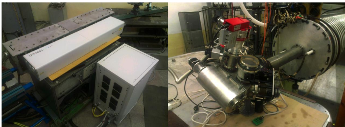
Рис. 1.3.2. Новый лазерный источник на выходе ЛУ-20: Nd:YAG лазер и его источник питания (слева), мишенная станция на высоковольтной платформе
