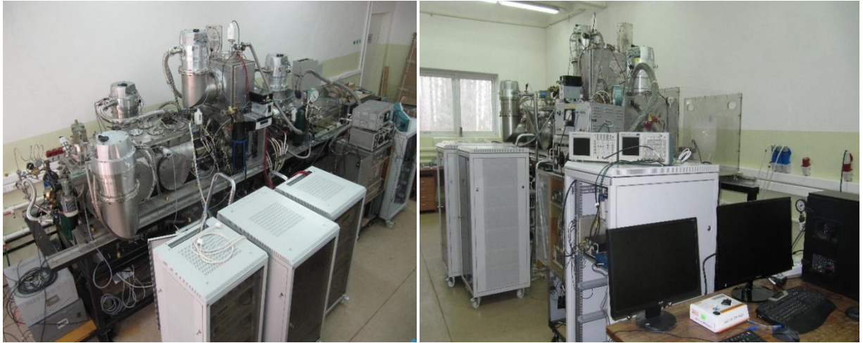
Рис. 2.2.2. Источник поляризованных протонов и дейтронов в стендовом экспериментальном зале во время испытаний
