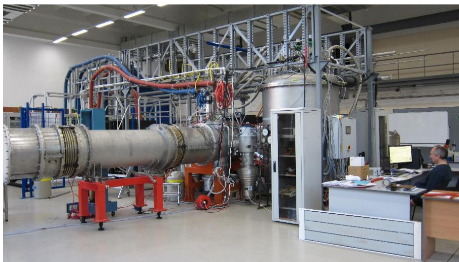
Рис. 1.7.3. Установка для тестирования СП магнитов для проектов NICA и FAIR
