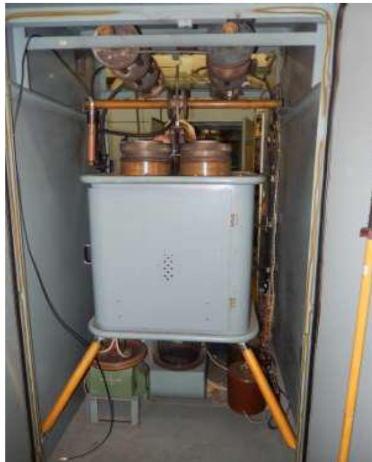
Рис. 2.2.27. Модулятор генератора «Родонит» созданный в начале 70-х: для обеспечения требуемого анодного тока генератора 220 А четыре модуляторные лампы ГМИ-34Б включены параллельно
